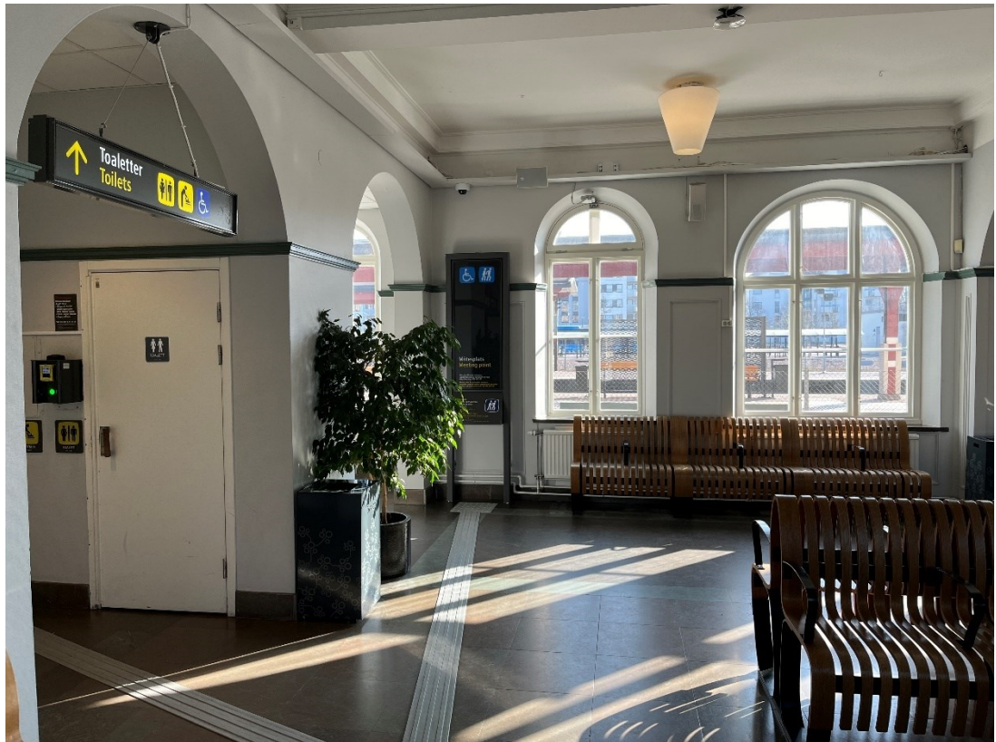
Figur B2. Stationshusets väntsal ligger i nära anslutning till spåren och har god sikt mot plattformarna trots stängslet som finns på plattformen närmast stationshuset mot spår 1. Väntsalens inredning är modern med nya skyltar och bänkar. I det äldre stengolvet har taktila vita stråk frästs in.
