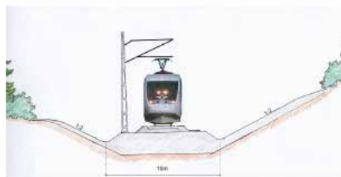
Järnväg i jordskärning.
