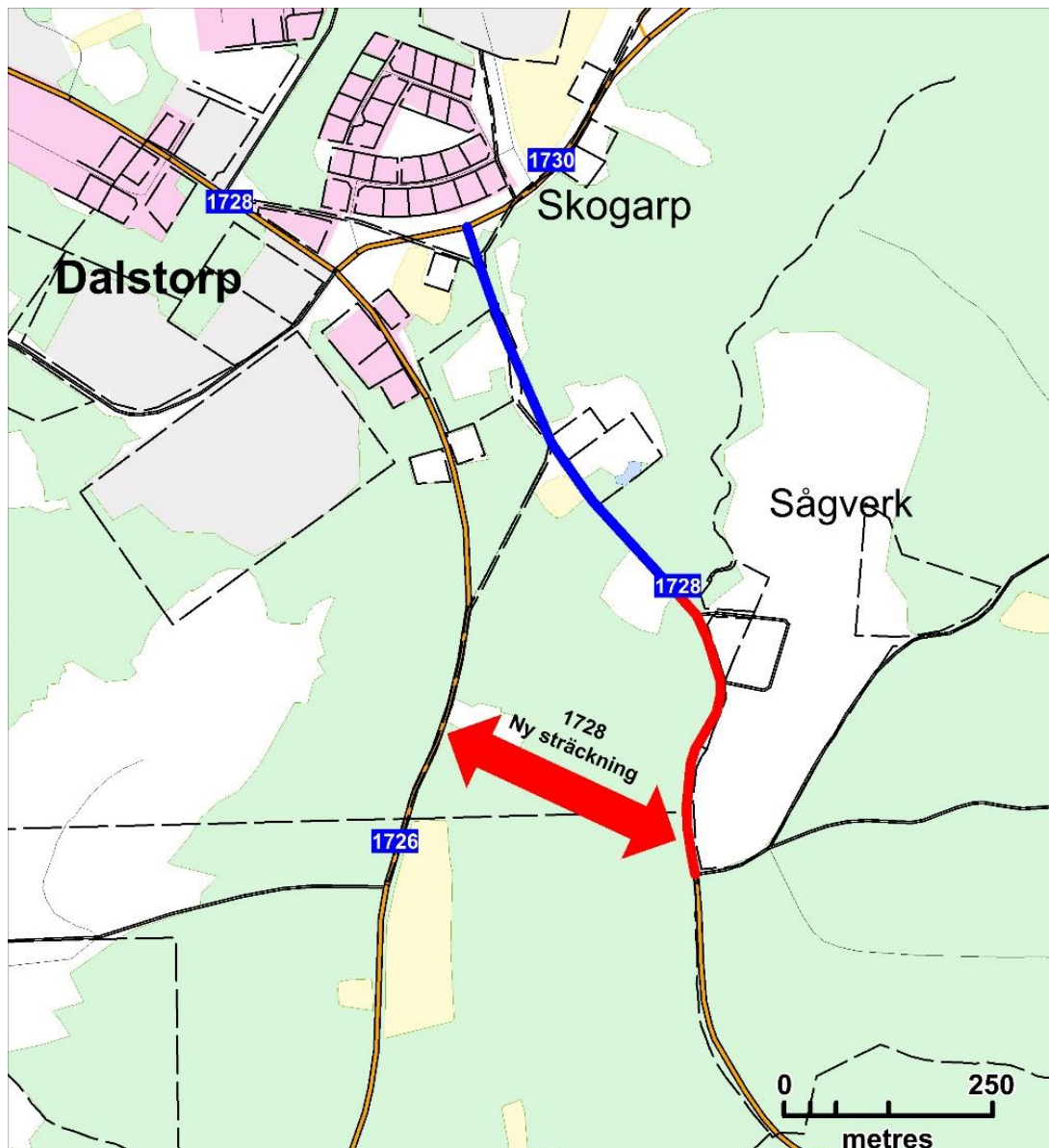
Figur 2. Trafikverket planerar att anlägga en ny tvärförbindelse mellan väg 1726 och 1728 som därmed får en ny sträckning. Röd pil anger ungefärligt planerat läge för ny väg. Vid ett genomförande av vägplanen övergår befintlig 1728 från Dalstorp centrum ner till sågverket (blå linje) till kommunal väg. Sträckan mellan ny väg och sågverket (röd linje) dras in som statlig väg och blir enskild väg som underhålls av sågverket.
