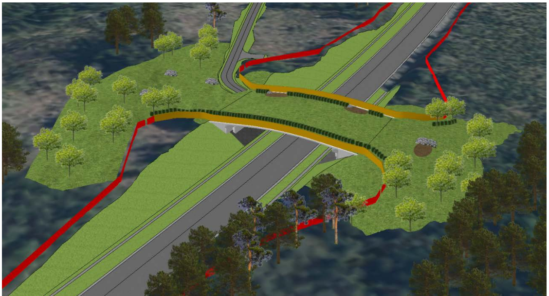
Figur 6.3.1:3 Vy ekodukt fågelperspektiv söderifrån, med grusad driftväg i bakgrunden. I bilden är föreslaget faunastängsel markerat med rött. Utdrag från Samordningsmodellen, Markera AB.
