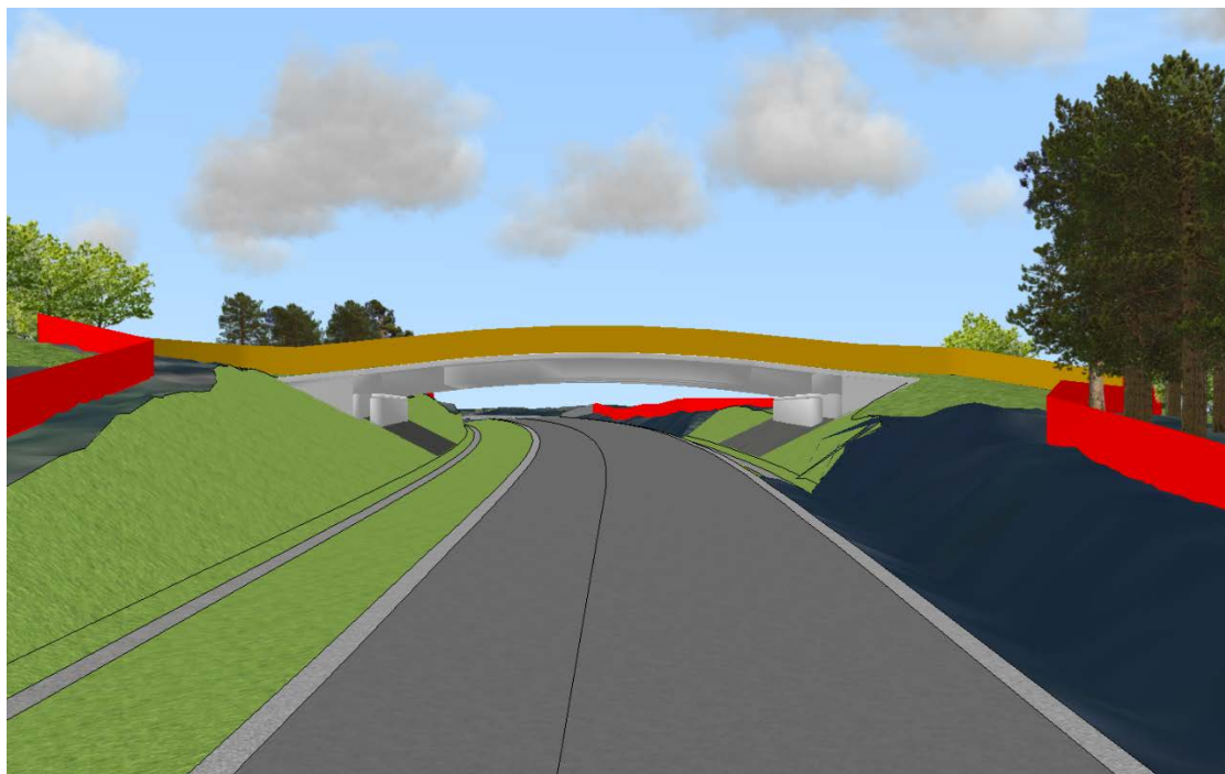
Figur 6.3.1:1 Vy ekodukt från sydväst. I bilden är föreslaget faunastängsel markerat med rött och befintligt viltstängsel visas i grått. Utdrag från Samordningsmodellen, Markera AB.
