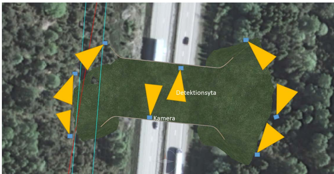
Figur 3. Principskiss för uppsättning av kameror, så att de tillsammans täcker in alla djur som rör sig över en ekodukt och intill dess mynningar (EnviroPlanning AB & Trafikverket, 2019). Skissen skall ses som schematisk då faunapassagens välvning och vegetationstäckning kan innebära förändringar i den slutgiltiga uppsättningen. Principen kan användas även för portar.
