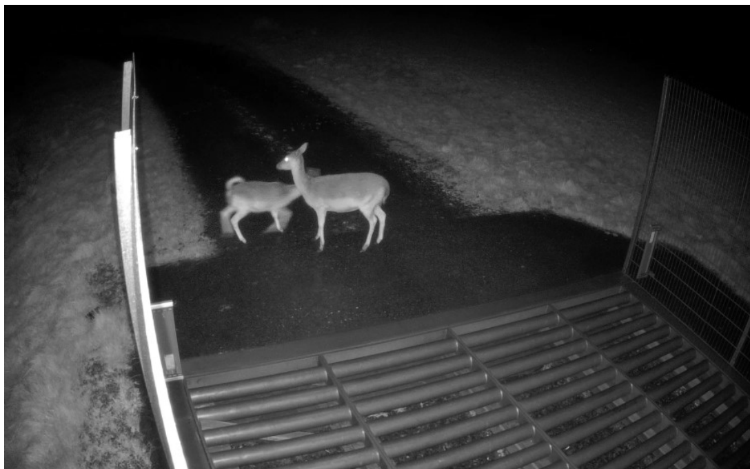
Figur 6. Bild som visar ungefärlig kameravy som behövs för att studera djurens nyttjande av färister eller stängselöppningar. Kameran är riktad mot natursidan utanför färisten. Dessa dovhjortar står ungefär 1,5 meter från färisten. Liknande kamerauppsättning kan användas för de förstudier som planeras.
