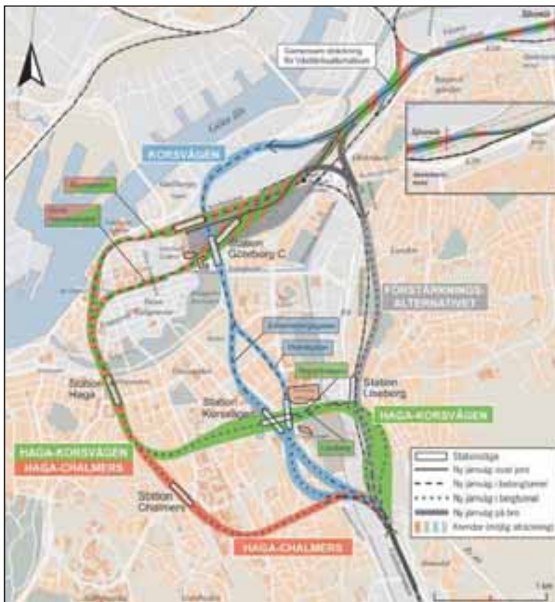
FIGUR 1.4. Västlänken järnvägsutredning. Karta över studerade alternativ. Det grönmärkade alternativet Haga-Korsvägen via Älvstranden valdes.
