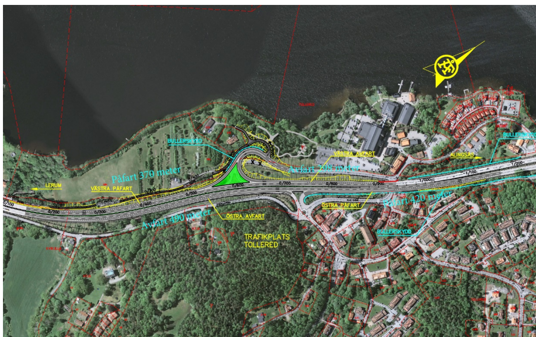
Figur 23. Översiktsbild med längder på av- och påfartsramper. Bilden täcker in hela det 1,1 km långa planområdet. Grön markering är ny yta mellan på- och avfartsramp i södergående riktning.
