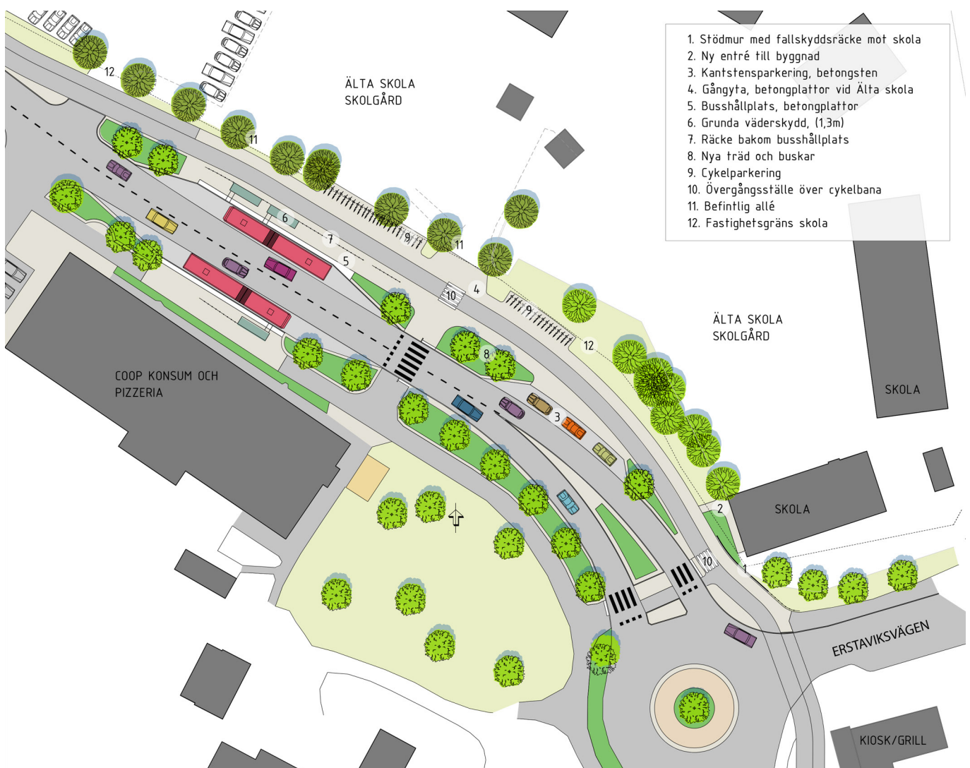
Bild 12. Princip för utformning vid Älta skola. Väg 260 smalnas av för att ge mer utrymme åt gång- och cykelvägen.
