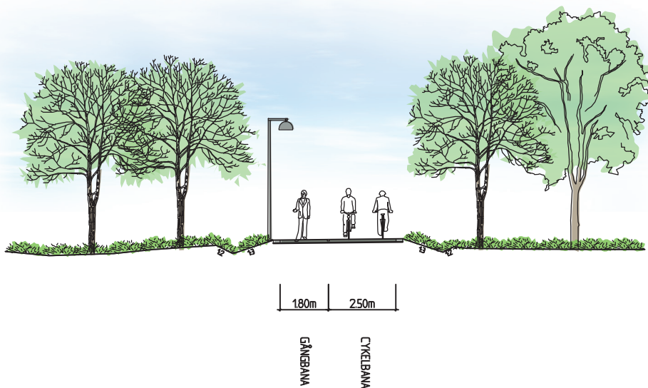
Bild 4. Typsektion friliggande GC-väg.
