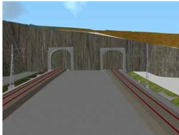
Figur 3.3. Tunneln med två separata tunnelrör.
