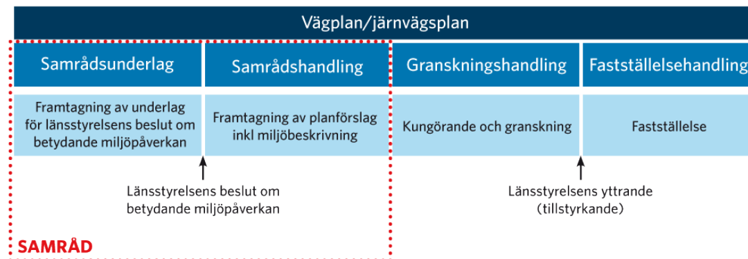
Figur 2. Vägplanens olika skeden. Figuren illustrerar planläggning av ett projekt som inte antas medföra betydande miljöpåverkan. Källa Trafikverket.
