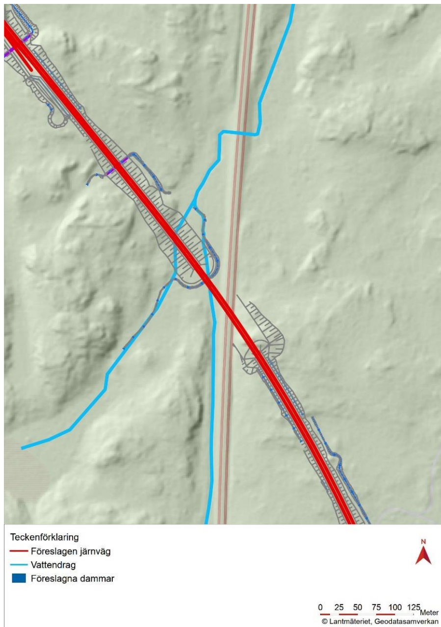
Figur 2.6. Omledning av Sågabäcken. Biflödet längs med väg 50 kommer att grävas om under byggskedet.
