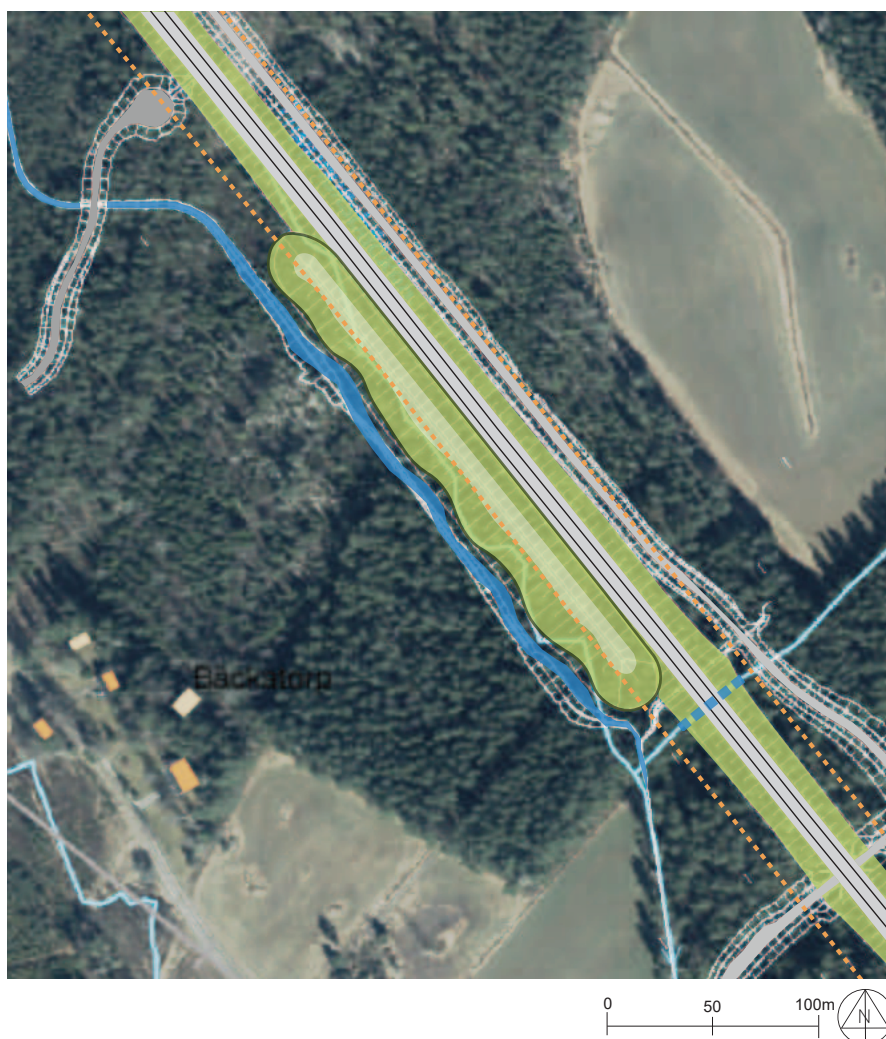
Figur 68 - En bullerskyddsvall anläggs i skogsområdet söder om järnvägen för att skydda närliggande bebyggelse från de bullernivåer som järnvägen ger upphov till. Bullerskyddsvallens släntfot ges en böljande form och diket likaså för att öka de biologiska värden som ett meandrande dike har jämfört med ett rakt.
