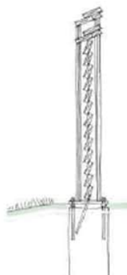
Figur 37 - De absorberande bullerskyddsskärmarna ges en utformning i trä likt skärmarna i tidigare etapp (Dunsjö-Jakobshyttan). På insidan förses de med ljudabsorbenter som ytterligare dämpar bullret genom att hindra ljud från att studsas tillbaka.
