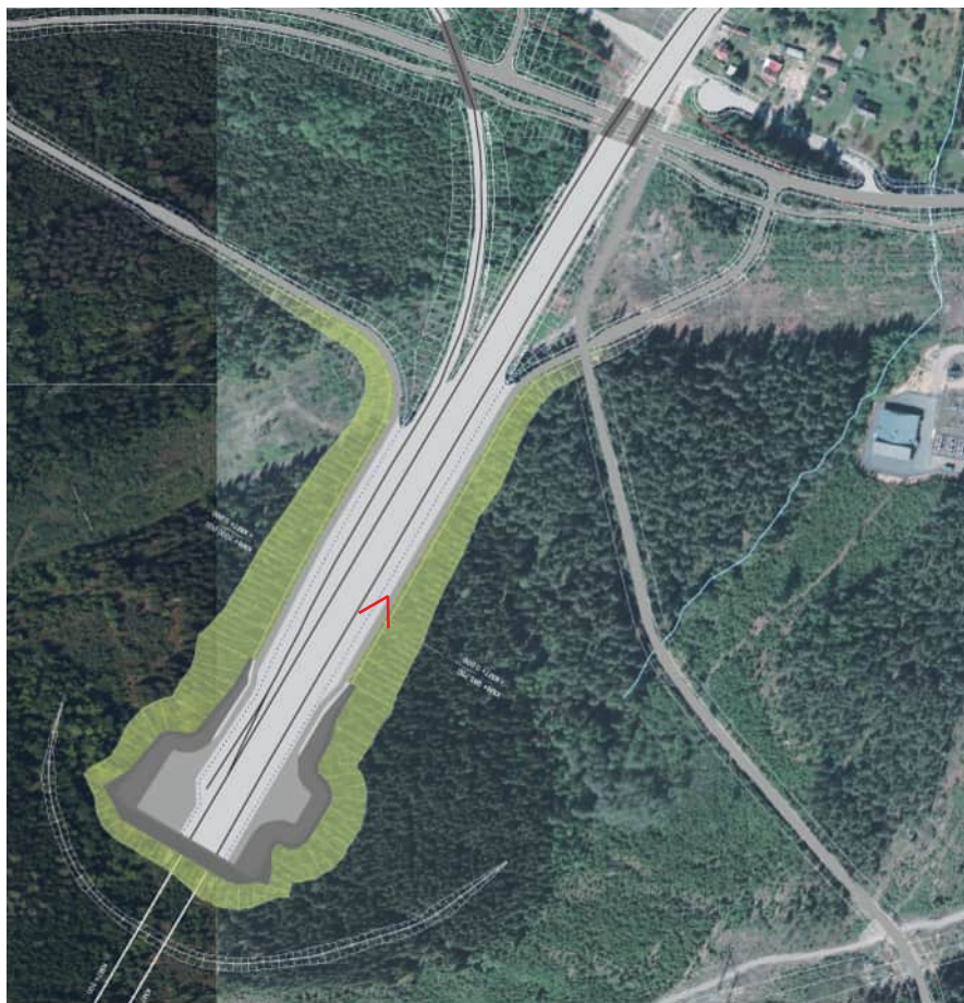
Figur 61 - Före tunneln övergår järnvägen från att gå på bank till skärning. Ingreppet i den befintliga skogsmarken blir stort men är en förutsättning för att värdefull skogsmark ovanför tunneln ska kunna bevaras. Slänterna täcks med lokala avbaningsmassor som får dem att läka samman med den omgivande skogsvegetationen. På makadamytan mellan spåren anläggs räddningsplatser. Med tiden kan makadamytan tillåtas att utvecklas till ruderatmark som är värdefull ur ett biologiskt perspektiv. Detta bör beaktas vid framtida skötselåtgärder.
