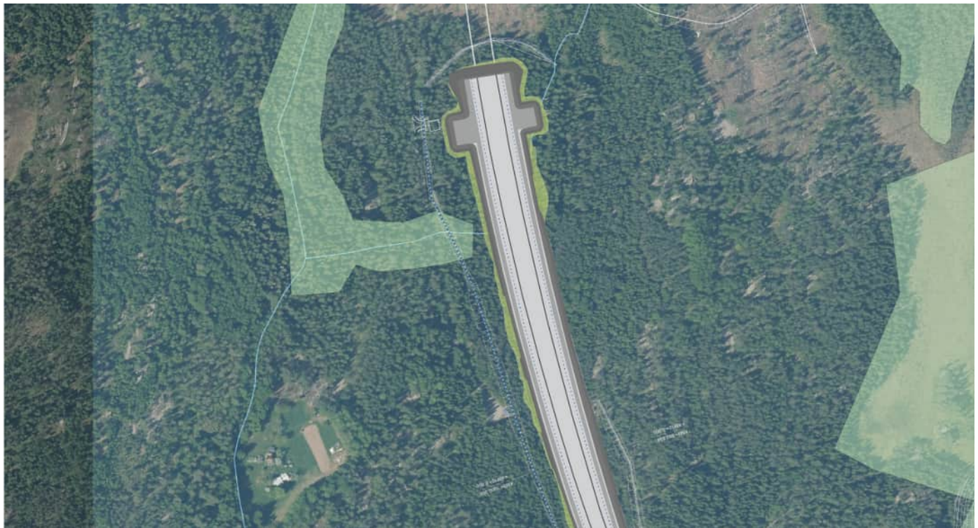
Figur 64 - Söder om tunneln går järnvägen i skärning en lång bit. Branta bergskärningar innebär att skogsmark i stor utsträckning kan sparas. De ytor av skogsmark som ändå påverkas ovanför bergskärningen täcks med avbaningsmassor för att artsammansättningen ska bli densamma som i omgivande vegetation. Liksom vid norra tunnelpåslaget tillåts makadamytan mellan spåren att utvecklas spontant till ruderatmark.
