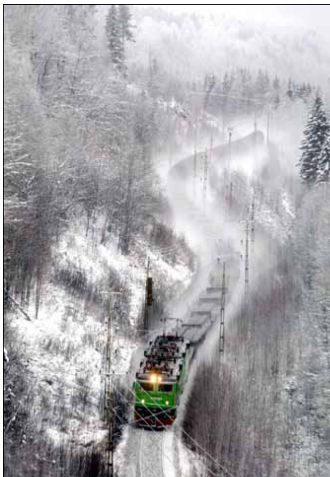
Figur 3.1.1 Stambanan genom övre Norrland är både backig och krokig, vilket begränsar vagnvikterna och hastigheten.
