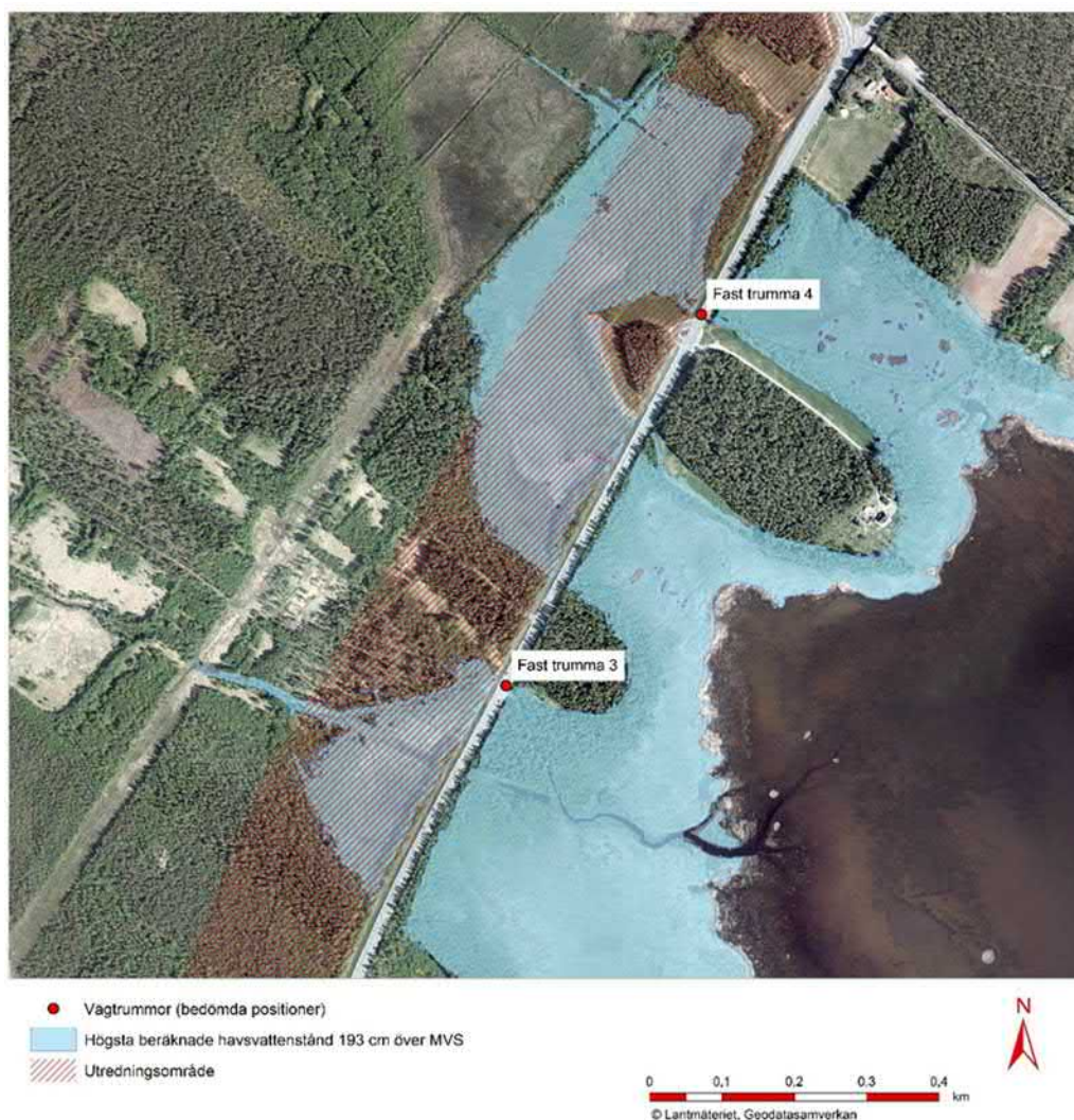
Figur 4.5-11 Utbredning av högsta beräknade havsvattenstånd när vattnet trycker upp genom trummorna under E4.
