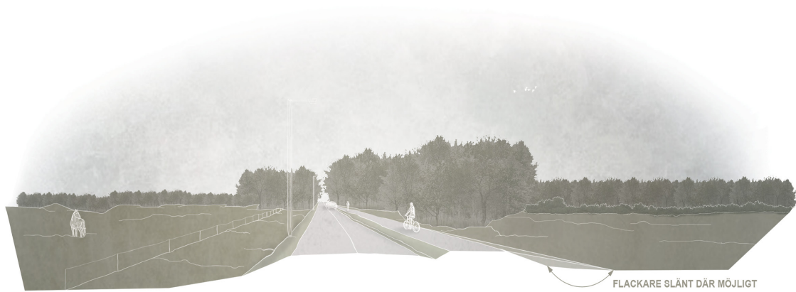
Figur 9. Illustrativ skiss. Gång- och cykelvägen avgränsas med skåldike mot körbanan. Innerslänt ansluter till omgivningen. Flackare slänt där möjligt.
