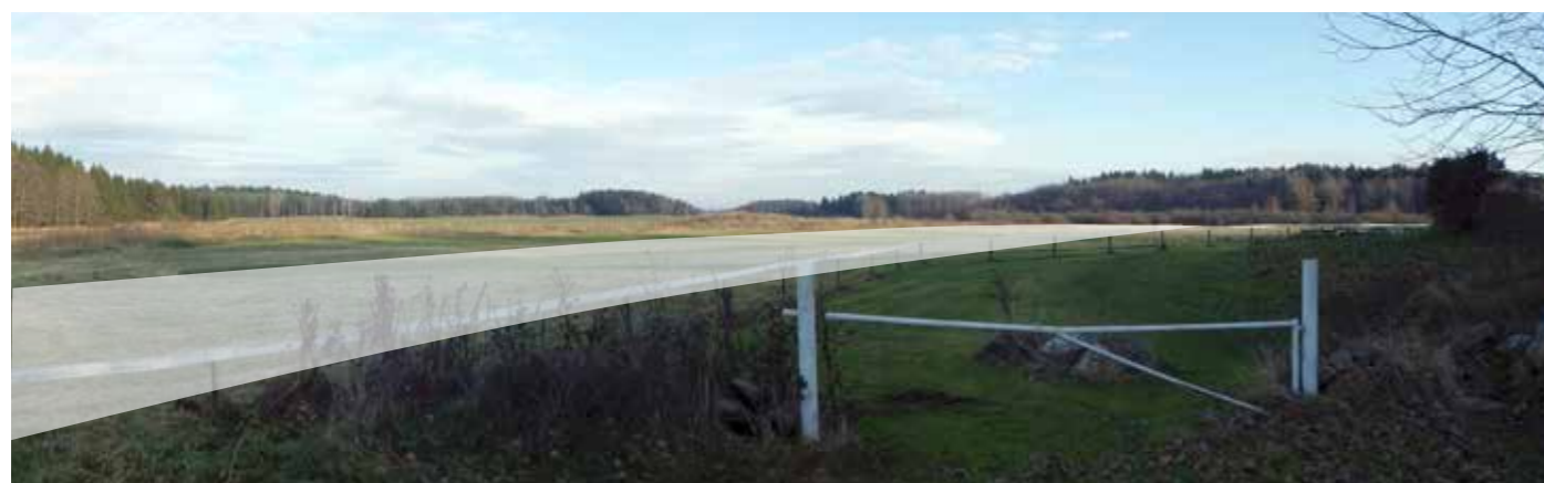
7.1 Exempel på möjlig väglinjeföring mellan modellplansflygplatsen och Snöbergen. Väglinjeföringens målsättning är att spara åkerholmarna och undvika att bryta siktlinjerna.
