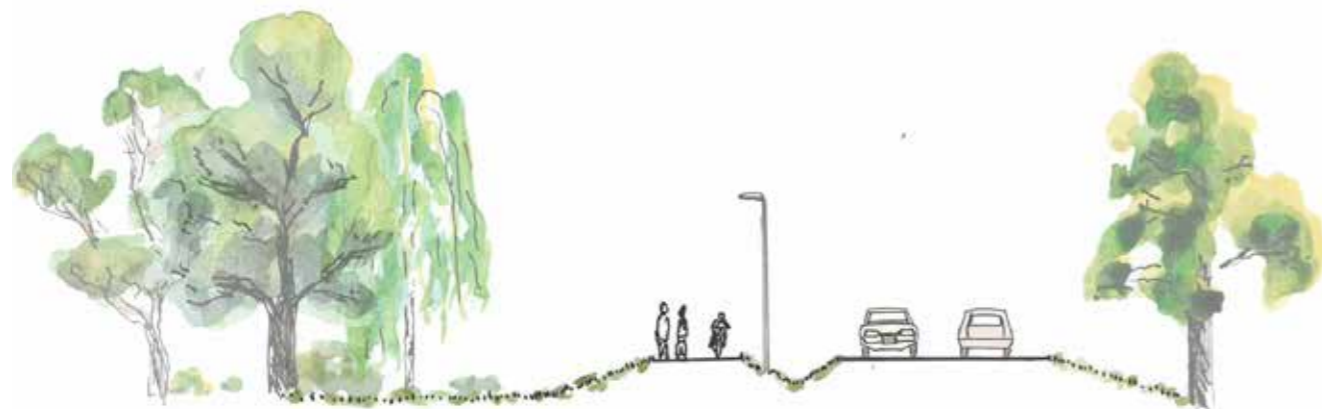
4.13 Exempel på sektion med GC-väg intill väg 268 där det finns plats vid sidan av vägen-
