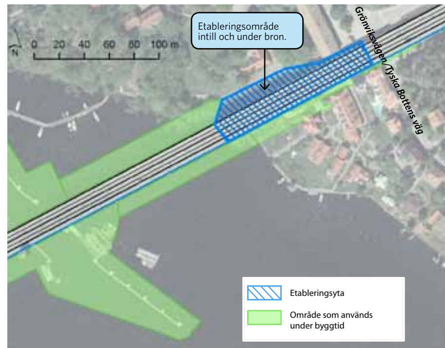
Figur 8.5 Etableringsyta och arbetsområden vid Nockebybron
