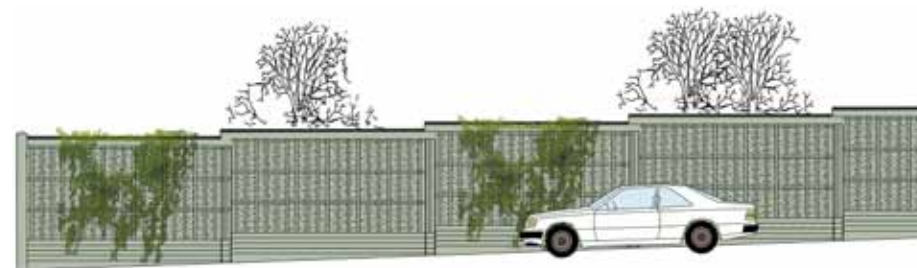
Figur 6.18 Gestaltungsprogrammets förslag till utformning av den 2,5 meter höga bullerskärmen i Tapström.
