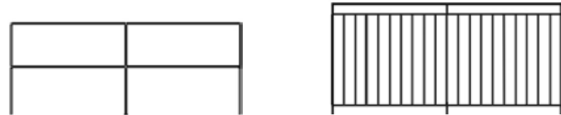
Olika typer av räcken som kan vara aktuella ovan stödmuren samt som avskiljare mellan gångbana och cykelbana vid väderskydd.
