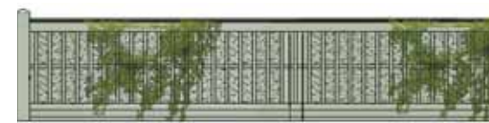
1,5 meter hög bullerskärm på vägens östra sida.
