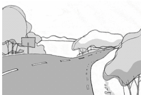
Vägmärke placerat så att utblicken lämnas fri. Vägmärket tar stöd i vegetationen.
