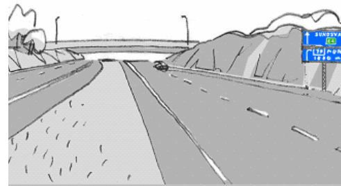
Vägmärke placerat så att det tar stöd i bergsskärningen bakom.
