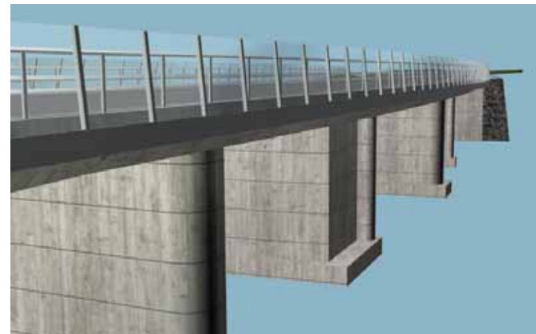
Den nya Tappströmsbron är en öppningsbar vridbro. Bullerskärmar görs genomsiktliga. Bild hämtad ur VR-modellen.
