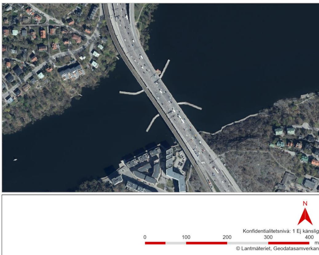
Figur 6. Ortofoto över av ledverk vid Gröndalsbron, som består av betongbalkar på vardera sida om farleden.
