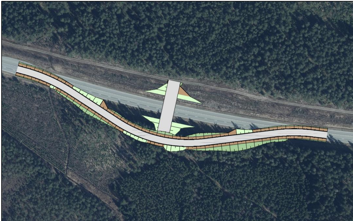
Figur 36. Principiell utformning av tillfällig förbifart söder om väg 25 vid faunabro 2, väster om Moasjön.
