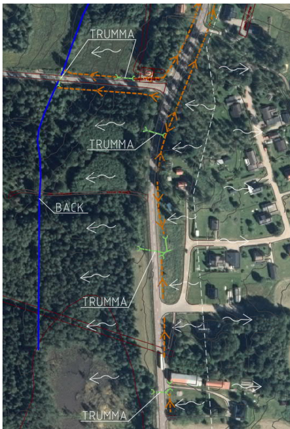
Figur 16. Visar den befintliga vägsträckningen och lutningar i terrängen, flödesriktningar på befintliga diken (orange), samt befintliga trummor (grönt). Ortofoto från Lantmäteriet.
