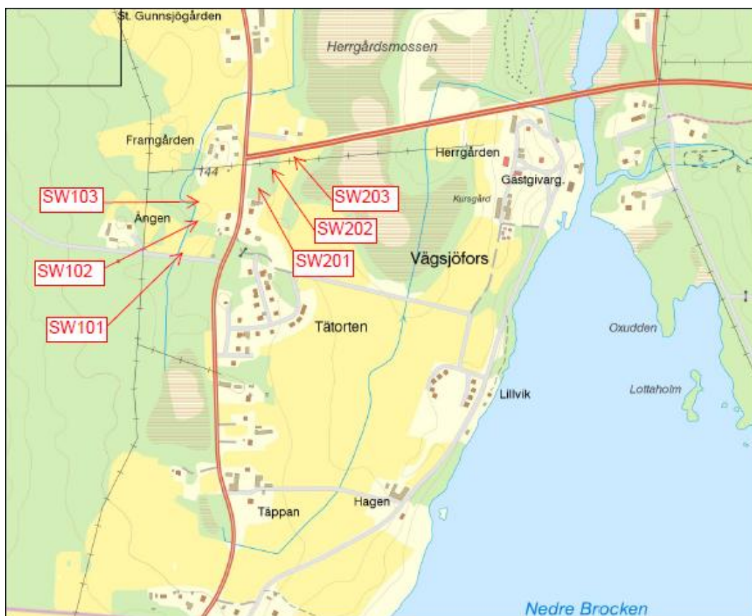
Figur 10. Karta över geotekniska undersökningspunkter.
