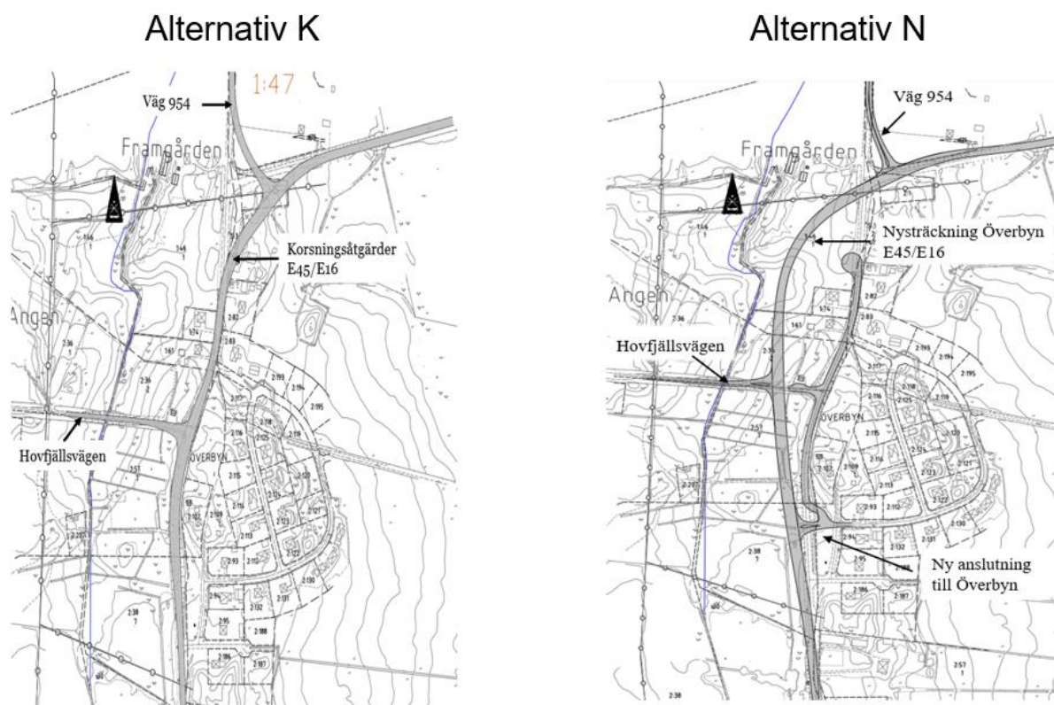
Figur 1. Karta över alternativen. Alternativen benämns alternativ K för korsningsåtgärder och alternativ N för väg i nysträckning förbi Överbyn.
