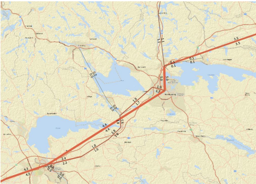
Figur 6: Passagerarflöden tåg miljoner passagerare per år i UA Huvudalternativet 2040 med zoomning på sträckan Norrköping-Linköping där banan delvis får en annan sträckning. Regional och nationell trafik inklusive lokaltåg (pendeltåg).
