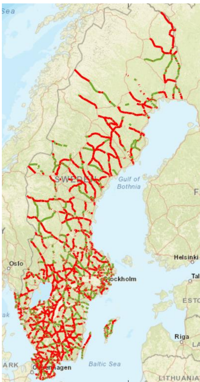
Figur 12 Lokalisering av justerade länkhastigheter, rött markerar sänkningar och grönt är ökning av hastigheten.
