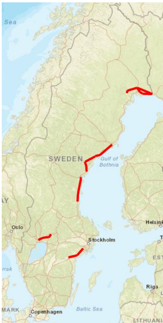
Figur 13 Illustrerar sträckor där kapaciteten i järnvägsnätet reducerats som en kalibreringståtgärd för att styra om godsflöden till kända rutter.
