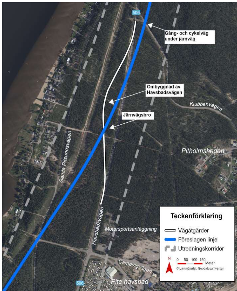
Figur 10.2-6. Vägätgärder på Havsbadsvägen (väg 506) samt passage för gång- och cykelväg.
