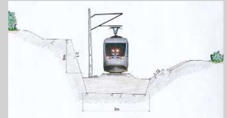
Järnväg i bergskärning.
