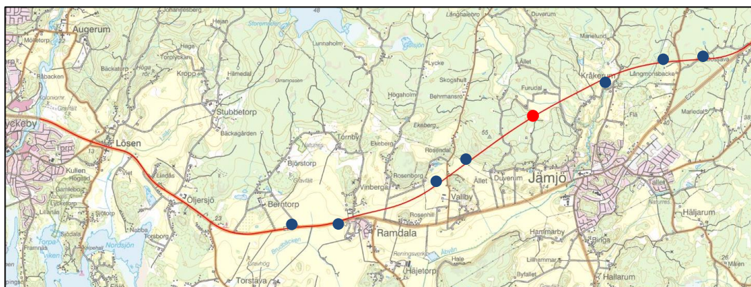
Figur 28: Drift- och nödfickors placering redovisade med blått och katastroföverfartens placering redovisad med rött.
