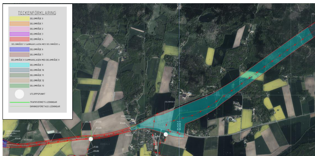
Figur 30: Översiktskarta av framtida avledning av dagvatten för delområde 7 och 9. Röda pilar markerar flödesriktning för dagvattnet och de vita prickarna markerar anslutningspunkt/lågpunkt.
