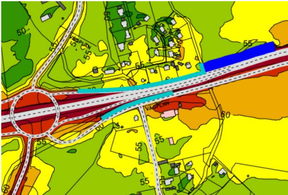
Figur 49. Karta som visar ekvivalenta ljudnivåer i Lösen två meter ovan mark efter utbyggnad, med åtgärder enligt planförslaget. Ljusblå linjer är bullerskärmar och mörkblå linje är bullervall.
