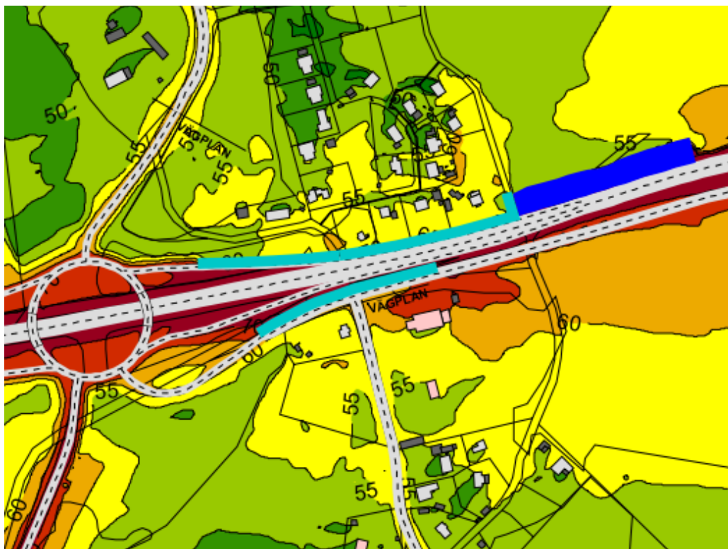
Figur 3. Förslag på skärmar och vall som bullerskydd för Lösen.
