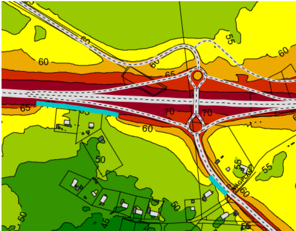
Figur 8. Förslag på skärmar som bullerskydd för fastigheterna i Torstäva.
