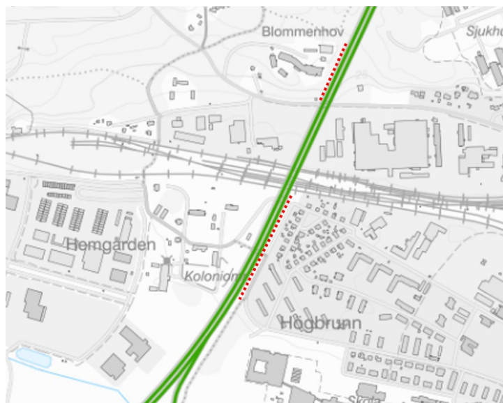
Figur 20. Ungefärlig placering av brandskyddsskärmar, markerade med röd streckad linje.
