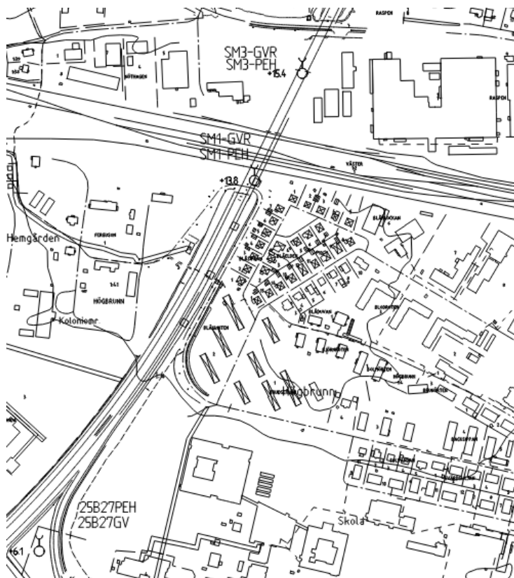
Figur 6: Installerade grundvattenrör benämnda SM3GVR, SM3PEH, SM1GVR, SM1PEH, 25B27GV och 25B07PEH.
