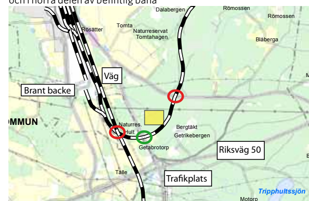
Figur 4.3 Passagen med störst problem i utredningsområdet: kurvan där befintlig järnväg går på bro över stambanan. Spåret har brant lutning följt av skarp kurva. Hastigheterna är låga i backen och i kurvan. På och intill banan trängs många intressen som riksväg 50 med trafikplats, naturreservat och planerad kraftstation.
