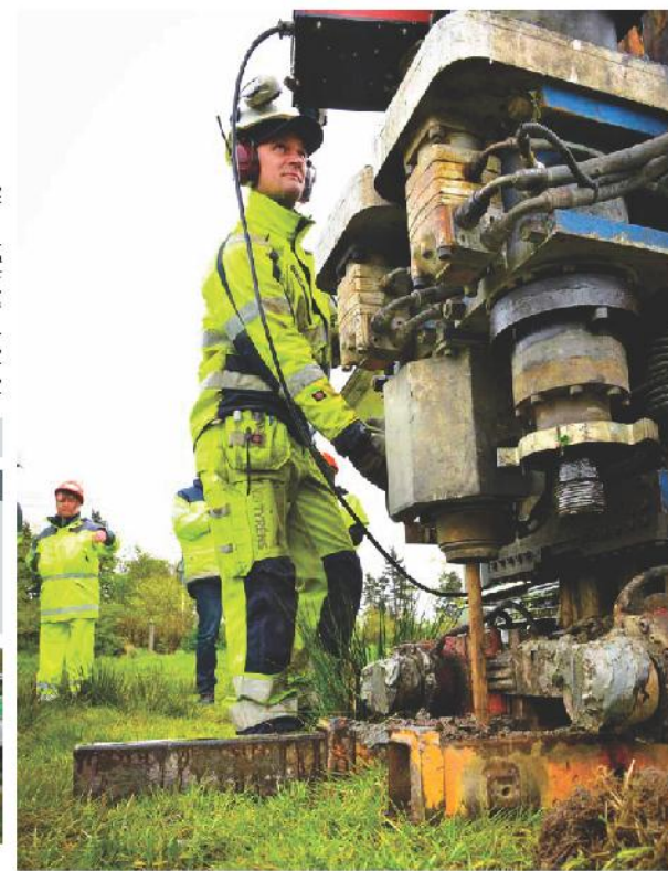
VINGFÖRSÖK. Geoteknikern Jonas Forslund mäter hållfastheten i marken. Mätningarna görs med ungefär 50 meters mellanrum.
