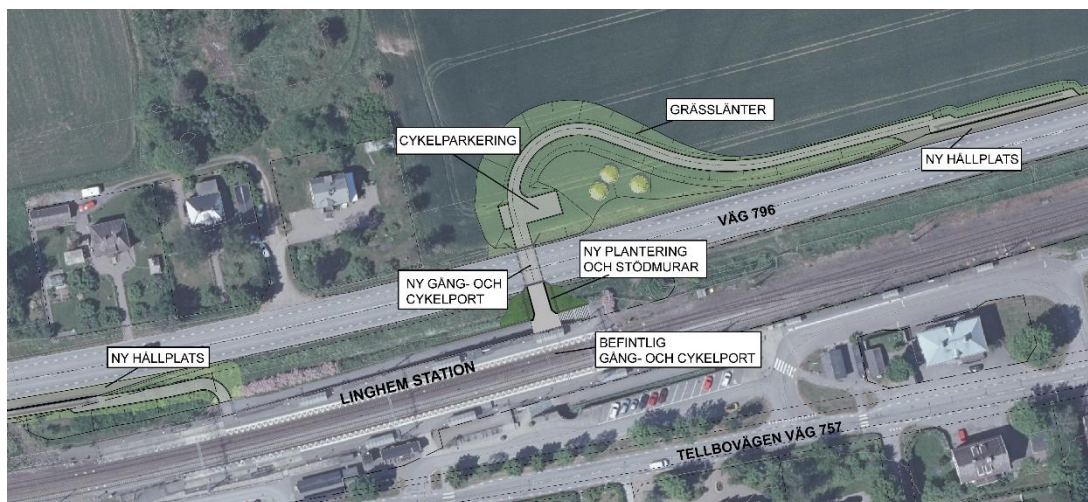
Figur 17. Översiktlig illustrationsplan över anläggningen med två nya hållplatser för buss och ny gång- och cykelport.
