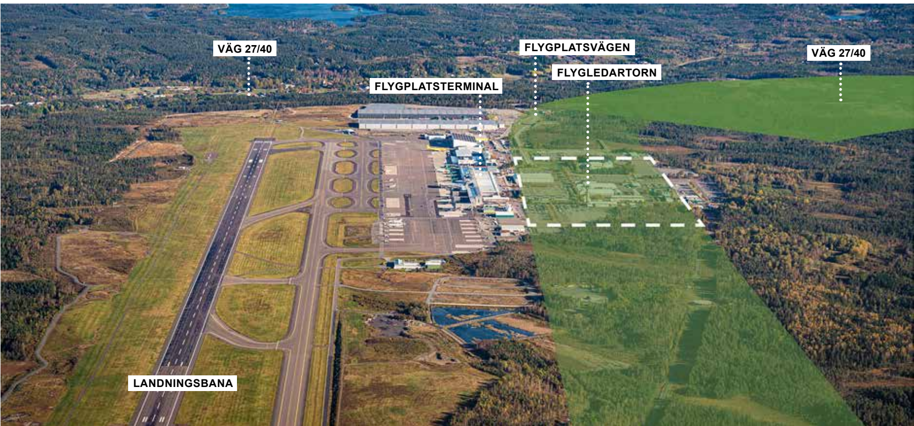
Figur 8.7 Vy från söder, flygfoto över Landvetter flygplats med stationsalternativ L3. Att korridoren är bredare norr om stationsläget beror på att korridoren även ska kunna ansluta till övriga stationsalternativ.
