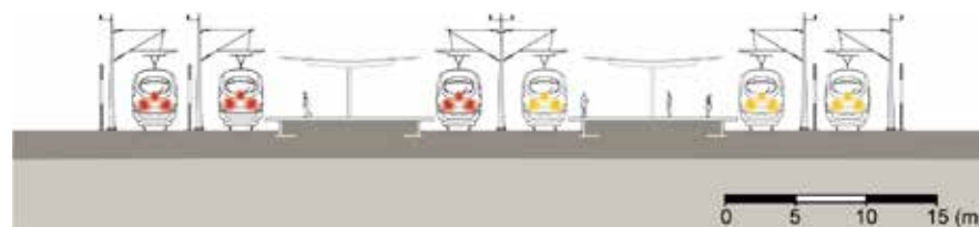
Figur 3.10 Exempel på station i markplan, huvudbana med sex spår.
