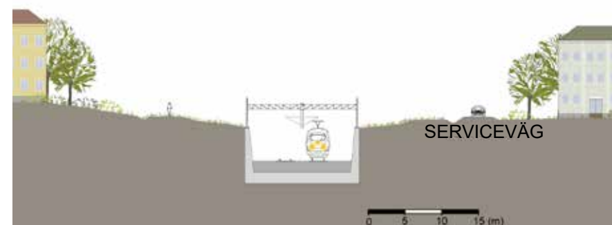
Figur 3.15 Illustration när järnväg går i betongtråg.
