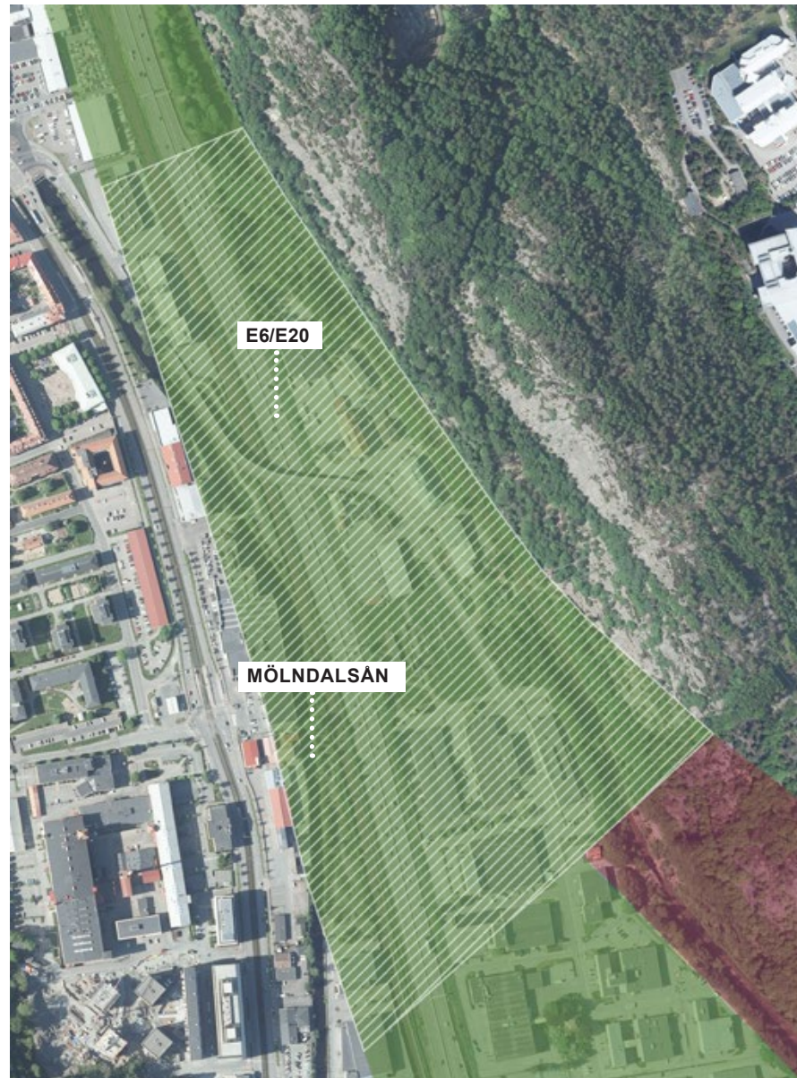
Figur 6.20 Möjligt område för planskild korsning mellan den nya järnvägen och Väst kustbanan. Inom det markerade området korsar spårerna för den nya järnvägen under Väst kustbanan och E6/E20 i flera olika nivåer, se Figur 6.21 och Figur 6.22. E6/E20 behöver läggas om i en östligare sträckning för att de nya spårerna ska få plats. Även Mölnalsån riskerar att påverkas negativt.
