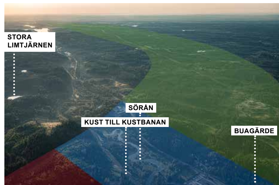
Figur 155. Flygfoto över Söråns dalgång med korridorsalternativ illustrerat i bild, vy mot sydost. Den röda färgen illustrerar bergtunnel, den blå färgen illustrerar bro och den gröna färgen illustrerar anläggning i markplan. (Foto: Per Pixel, 2020)
