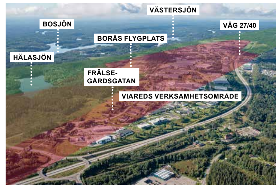
Figur 165. Flygfoto över fokusområdet Viared med korridoralternativ illustrerat i bild, vy mot sydväst. Den röda färgen illustrerar bergtunnel och den gröna färgen illustrerar anläggning i markplan. (Foto: Per Pixel, 2020)
