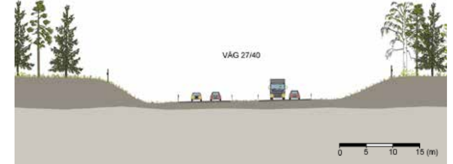
Figur 31. Typsektion av väg 27/40.
