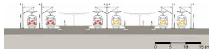
Figur 21. Exempel på station i markplan, huvudbana med sex spår.
