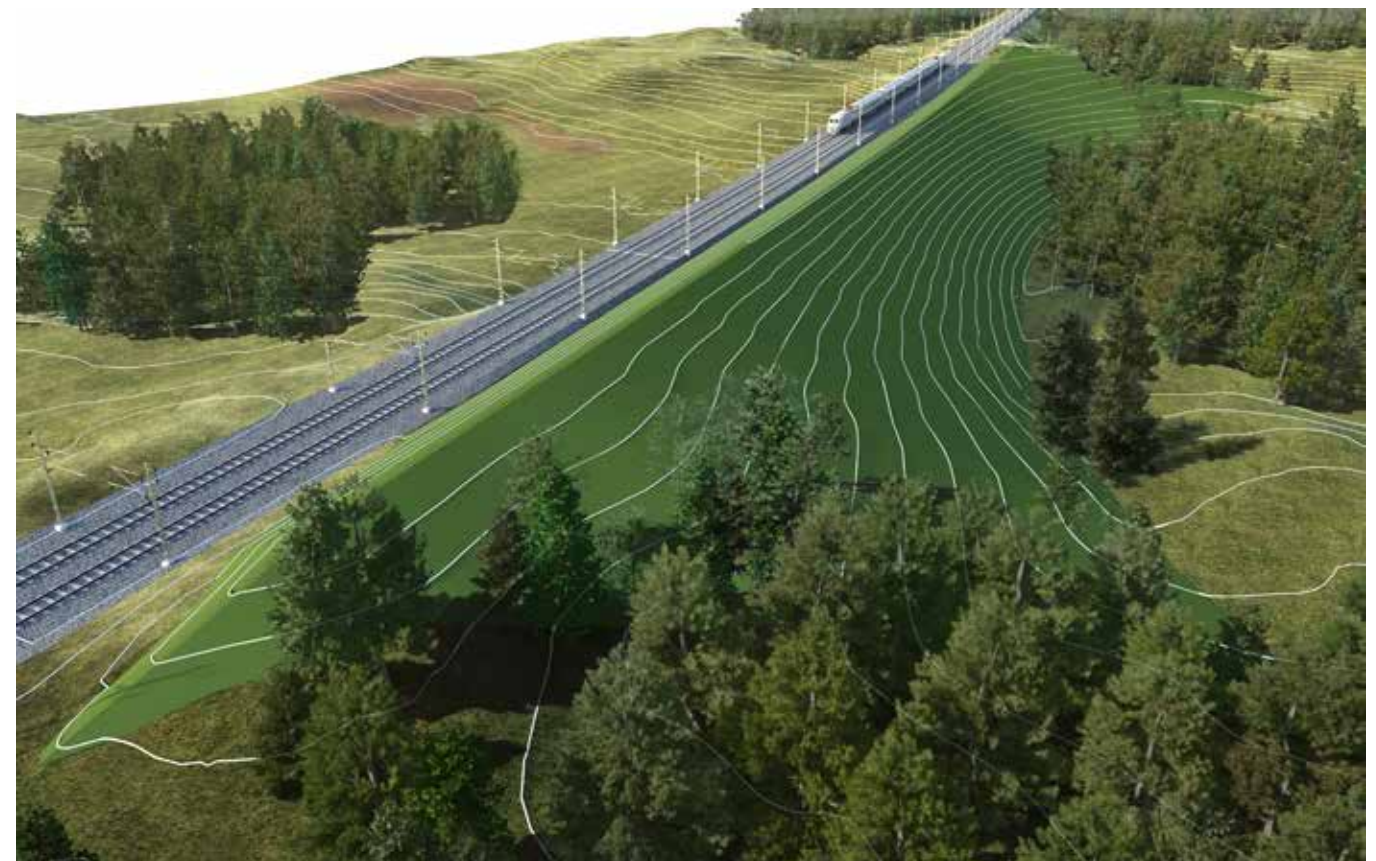
Figur 42. Principiell 3d-illustration av en landskapsanpassad bullervall med flackare slänter som ansluter till befintliga landformer och lutningar i landskapet. Klargrönt är bullervall. Vita linjer är höjdkurvor i landskapet.
