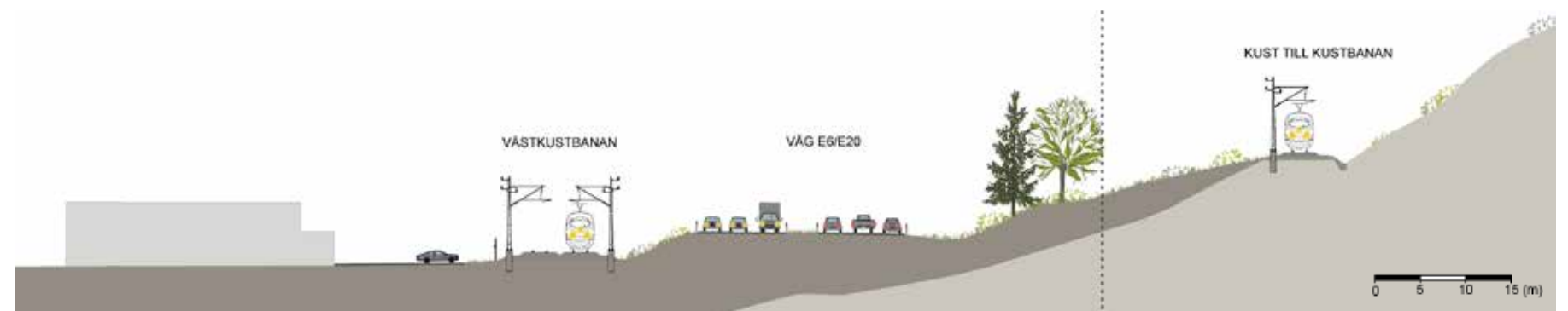
Figur 32. Typsektion i Mölndal. Till vänster i bild ses Väst kustbanan, i mitten väg E6/E20 och till höger Kust till kustbanan.
