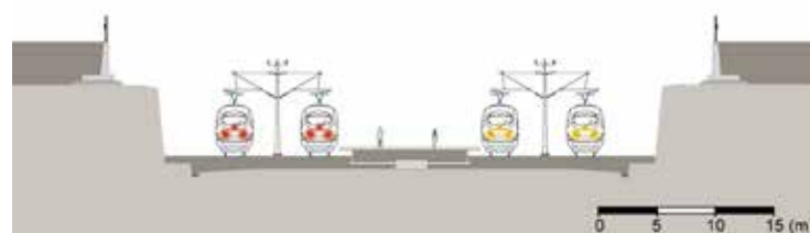
Figur 18. Exempelstation i öppet tråg med fyra spår.
