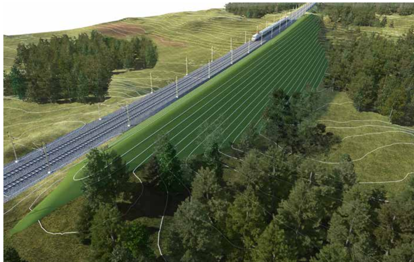
Figur 41. Principiell 3d-illustration av en grundutformning av bullervall. Klargrönt är bullervall. Vita linjer är höjdkurvor i landskapet.
