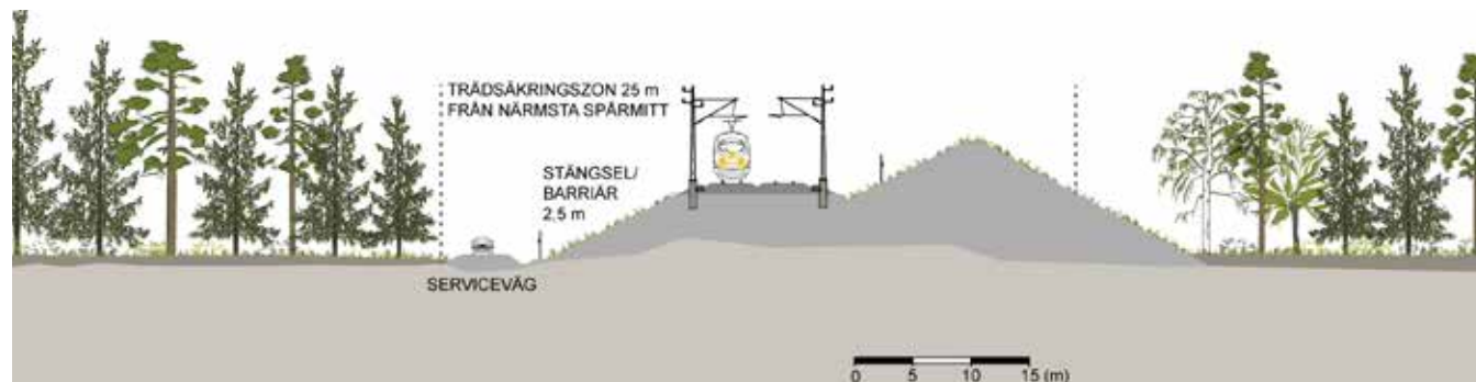
Figur 40. Illustration av en grundutformning av bullervall. En vall som anläggs med hänsyn till visuella aspekter kan med fördel vara ännu högre för att dölja även kontaktledningsstolparna som står längs järnvägen. Då stängsel placeras i en slänt ovan järnvägen kan stängselhöjden behöva höjas med hänsyn till bland annat vilt.
