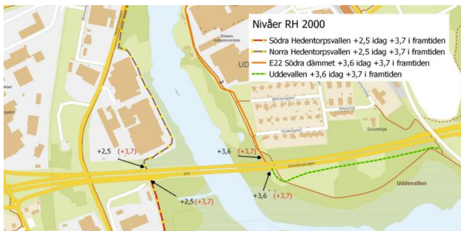
Figur 5. Befintliga och planerade markhöjder på vallar mot Helge å. Källa: Kristianstads kommun, 2016-11-07.
