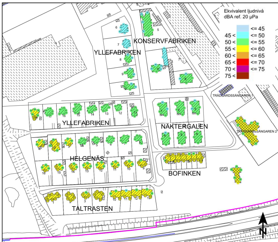
Figur 39 Utredningsalternativet med föreslagna skärmar. Beräknade bullernivåer, ekvivalent ljudnivå frifältsvärde vid våning med högst nivå år 2042, vid Udden norr om väg E22.
