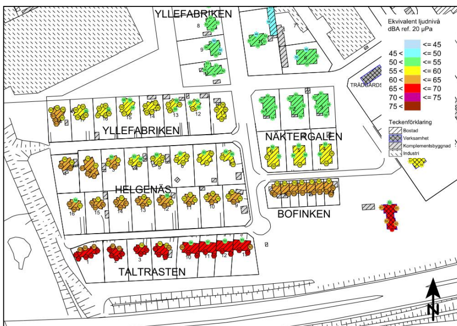
Figur 37 Utredningsalternativet, ekvivalent ljudnivå frifältsvärde vid våning med högst nivå för utredningsalternativet utan bullerskyddsåtgärder år 2042, vid Udden norr om väg E22.
