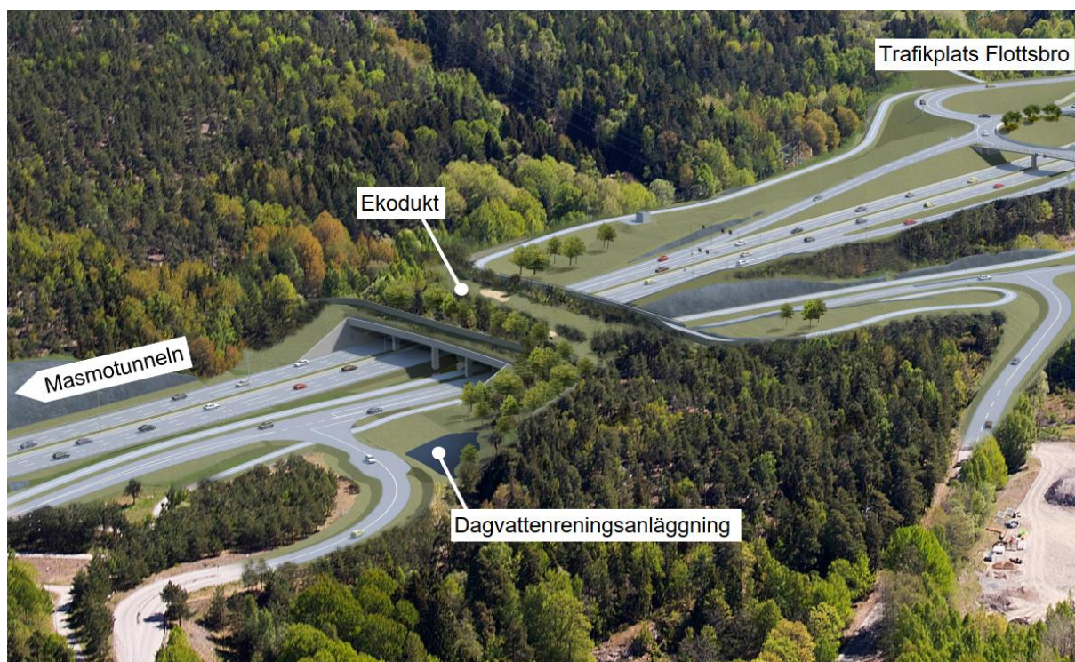
Figur 18. Figuren visar en möjlig utformning av ekodukten och läget för dagvattenreningsanläggningen. Figuren är hämtad från systemhandlingen. Véganläggningen har justerats till viss del i senare projektering varför figuren ska ses som en principskiss.
