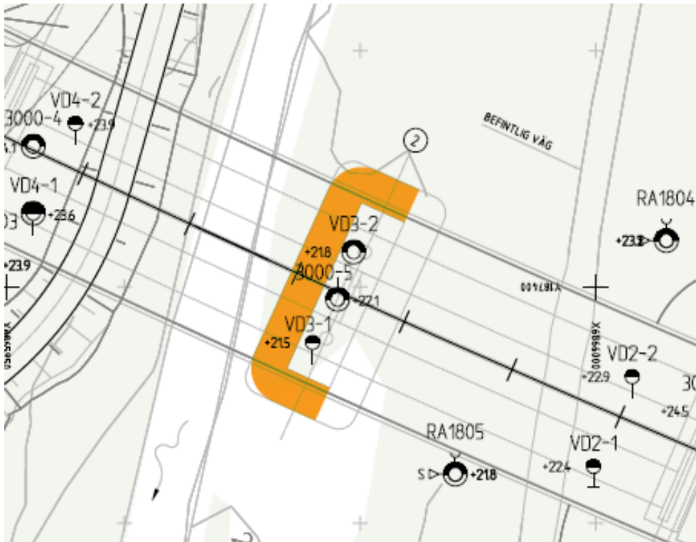
Figur 3. Illustration för projekterat erosionsskydd i anslutning till brostöd på norra sidan av Vattrångså. (Källa: Arbetsmaterial erosionsskydd, Ramboll 2021.)
