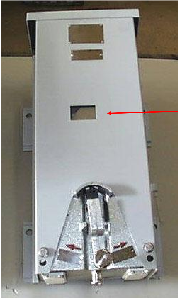
Bild 1: Motormanöverdon BAMYC2 för fjärrmanöver och handmanöver med vev.
