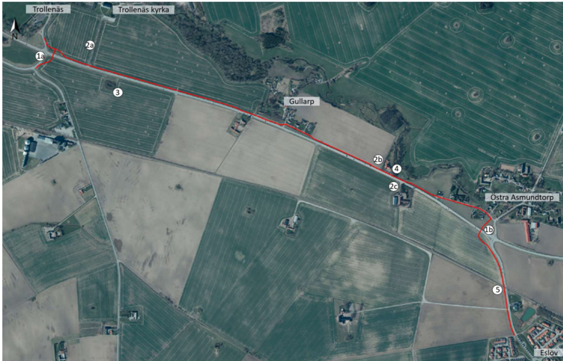
Figur 3.2–1. Planerad sträckning av gång- och cykelväg. Översiktlig redovisning av placering av plankorsningar samt gång- och cykelportar. 1a & 1b. Placering av gång- och cykelportar. 2a, 2b & 2c. Allé. 3. Småvatten med omkringliggande vegetation. 4. Trädvegetation. 5. Järnvägs korsning.
