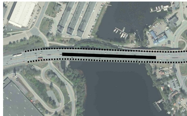
Figur 5.1 Alternativ utformning för Vårbybron med vägren som nytt körfält (streckad svart linje) samt hopgjutning (heldragen svart linje).
