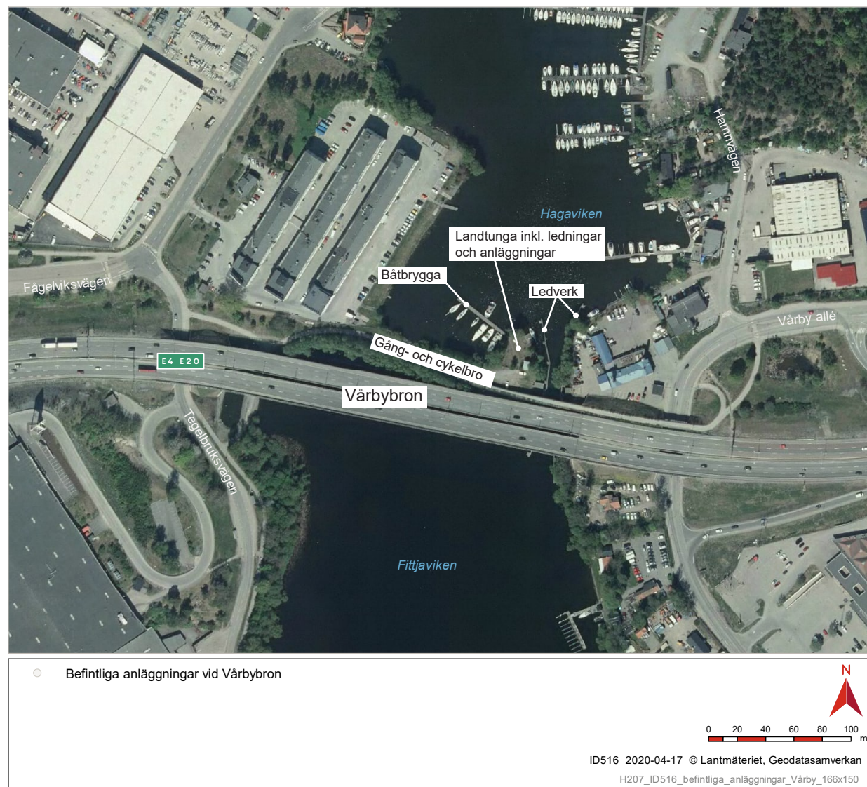
Figur 3.1 Befintliga anläggningar vid Vårbybron. Ledverket förväntas kunna vara kvar med oförändrad utformning. Resten av anläggningarna rivs ut för att ge plats åt den nya Vårbybron och bron för gång- och cykelväg över Fittjaviken.
