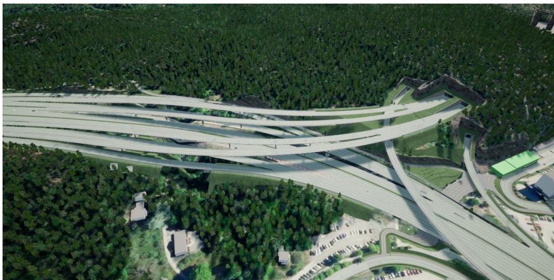
Figur 36. Trafikplats Gömmaren med anslutande rampbroar till E4/E20. Vänster i bild ansluts till E4/E20. I nedre högra hörnet ansluter E4/E20 till Vårbybron. Höger om bildens mitt syns Masmotunneln mynningar medan Gömmarravinen skymtar under broarna vänster om bildens mitt.
