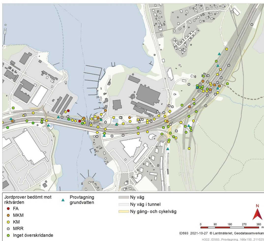
Figur 19. Provtagningspunkter för undersökning av föroreningar i jord.
