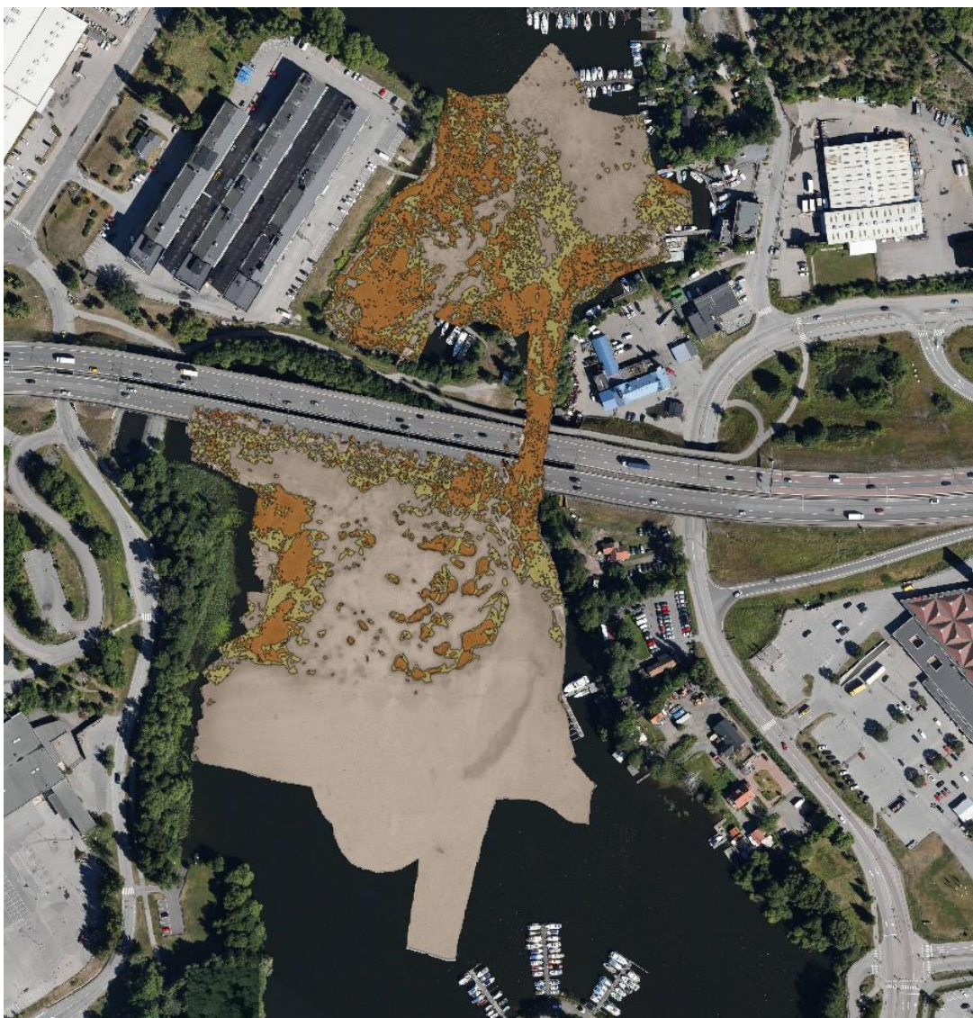
Figur 16. Översikt över bottenmaterial i mätområdet. Den ljusare färgen visar lerbotten. Övriga ytor utgörs botten av sand till grus med vissa siltinslag. Bildkälla Clinton Marine Survey AB, 2017.
