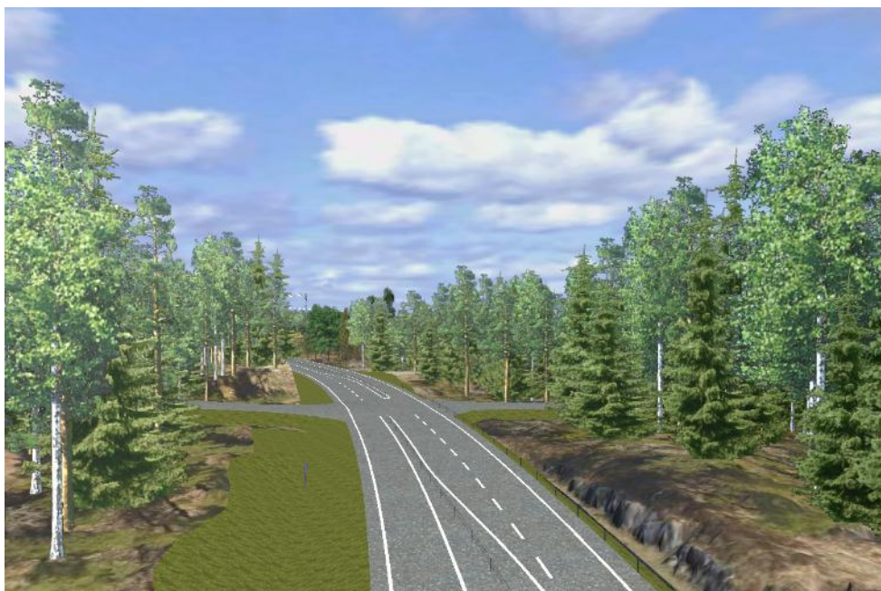
Bild 17. Korsningen vid km 1/500 utformas med typ C-korsning med svängfält i respektive riktning.
