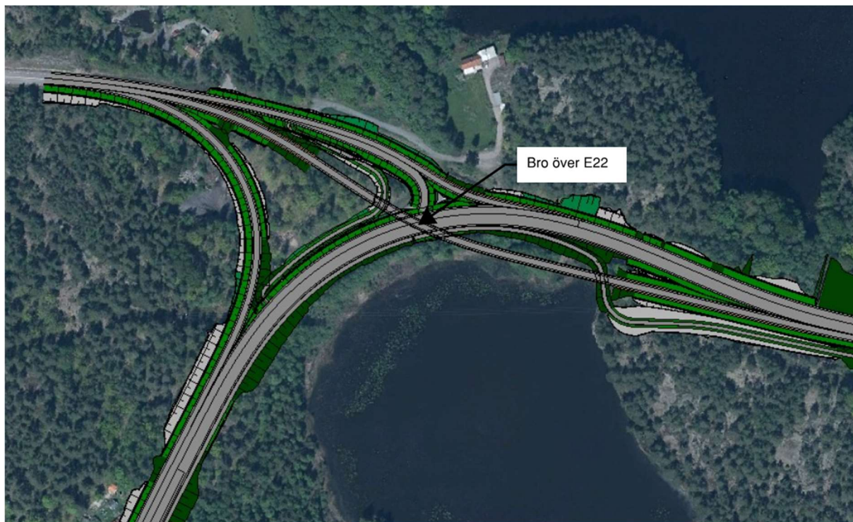
Figur 55. Utvecklat noll + B, principskiss utformning med "Fly over".
